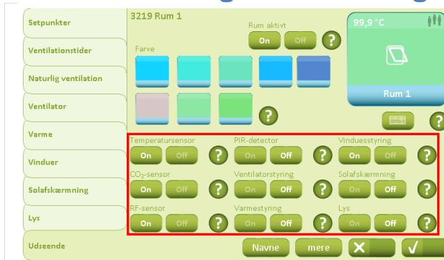
På fanebladet "Udsende" skal "Temperatursensor", "CO<sub>2</sub>-sensor" og "RF-sensor" sættes til "On" i samtlige rum, hvis der ønskes styring af den natrulige ventilation.
