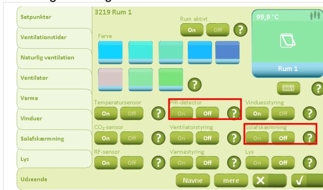
Ud over de sensorer/funktioner, der allerede er aktiveret i forbindelse med ventilation og varmestyring, skal "Solafskærming" sættes på "On".
