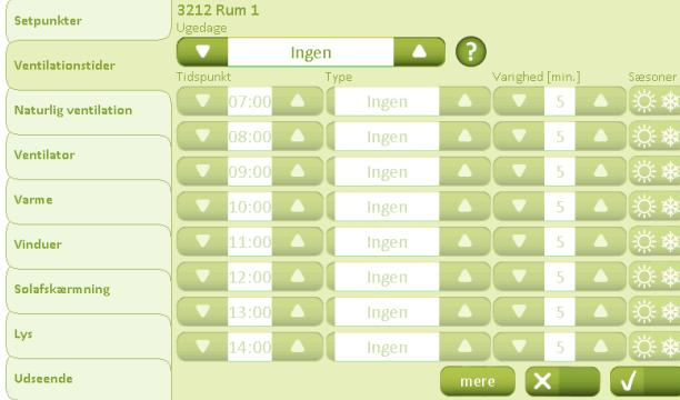
På fanebladet "Ventilationstider" fastlægges tiden/længden af udluftningen/ventilationen samt de tidspunkter, hvor der skal ventileres.
