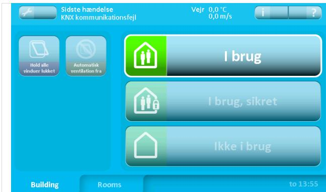
NV Comfort™ råder over 3 driftstilstande, hvorved systemet kan indstilles til de aktuelle forhold, se afsnit 2.2.1.
