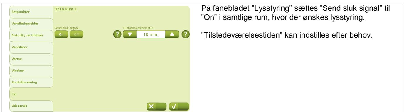
På fanebladet "Lysstyring" sættes "Send sluk signal" til "On" i samtlige rum, hvor der ønskes lysstyring.
