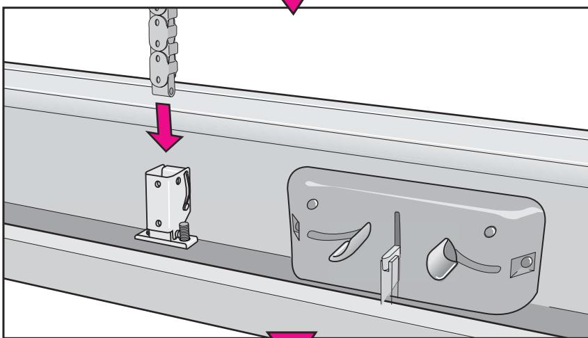
**Deutsch:** Die Lüftungsklappe schließen. Kette und U-Profil des Flügelbeschlages mittels Kettensplints verbinden. Die Lüftungsklappe öffnen; das Fenster ist jetzt betriebsbereit.
