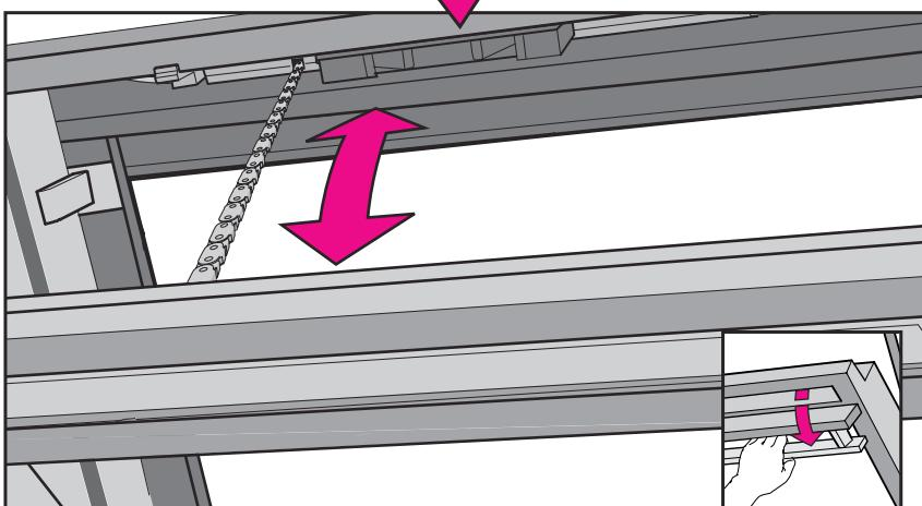
**Dansk:** Ventilationsklappen lukkes. Kæden forbindes med rammebeslagets U-profil ved hjælp af kædesplitten. Ventilationsklappen åbnes, og vinduet er nu klar til brug.
