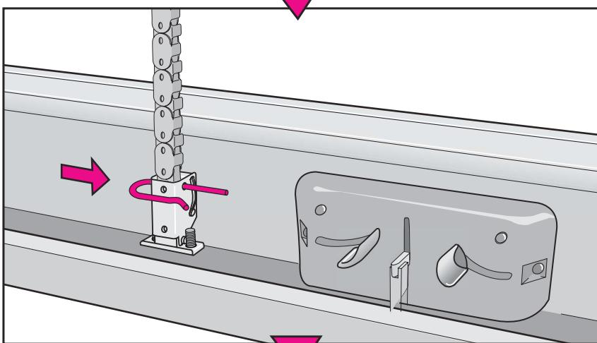
**Français :** Fermer le clapet de ventilation. Positionner l'extrémité de la chaîne dans la réception et mettre en place la goupille ; La fenêtre est maintenant prête à l'utilisation. Si l'alimentation électrique n'est pas encore réalisée, le moteur peut être testé en utilisant une batterie de 24 V maximum (ex : batterie de perceuse).
