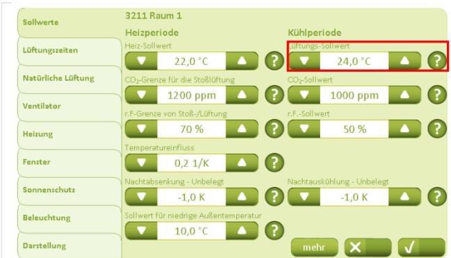
Unter „Kühlperiode“ kann der „Lüftungs-Sollwert“ für die einzelnen Räume nach Bedarf eingestellt werden.
