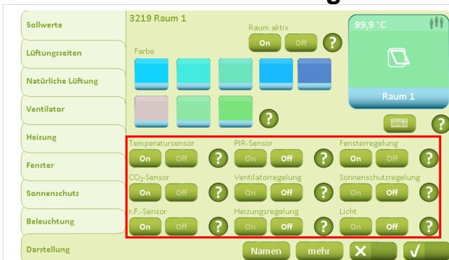
Unter der Registerkarte „Darstellung“ müssen „Temperatursensor“, „CO<sub>2</sub>-Sensor“ und „rF-Sensor“ in sämtlichen Räumen auf „On“ gestellt werden, wenn eine automatische Regelung der natürlichen Lüftung erfolgen soll.
