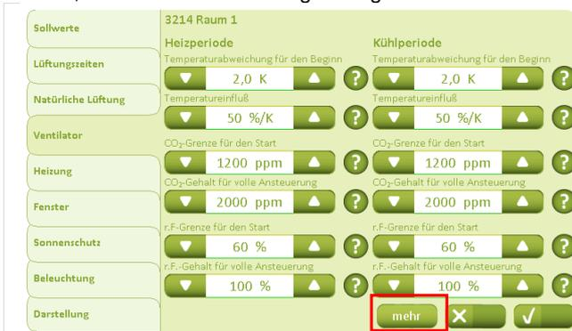
Die Lüftungs-Sollwerte für die Heiz- bzw. Kühlperiode werden angegeben. Der Sollwert für „Temperatur-Offset für Start“ geht vom Lüftungstemperatur-Sollwert aus, der unter „Sollwerte“ festgelegt wird (Kapitel 5).
