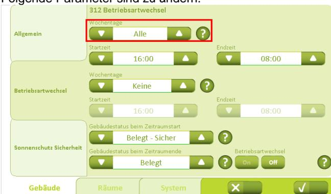
Unter Betriebsarten werden die „Wochentage“ von „Alle“ auf „Keine“ geändert. Das bedeutet, dass es keine besonderen Zeitpunkte gibt, zu denen nicht gelüftet wird, wenn dies gemäß den Temperaturen notwendig ist.
