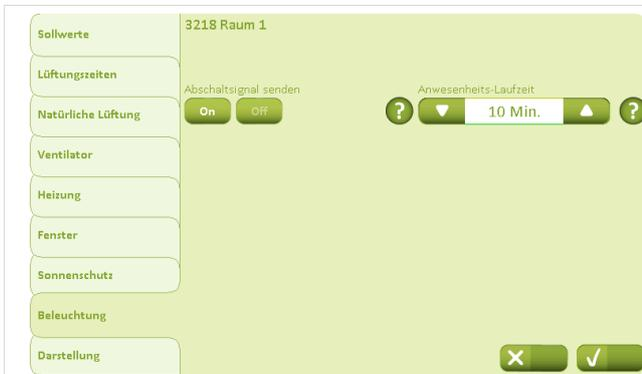
Unter der Registerkarte „Beleuchtung“ wird für alle entsprechenden Räume „Abschaltsignal senden“ auf „On“ gestellt.
