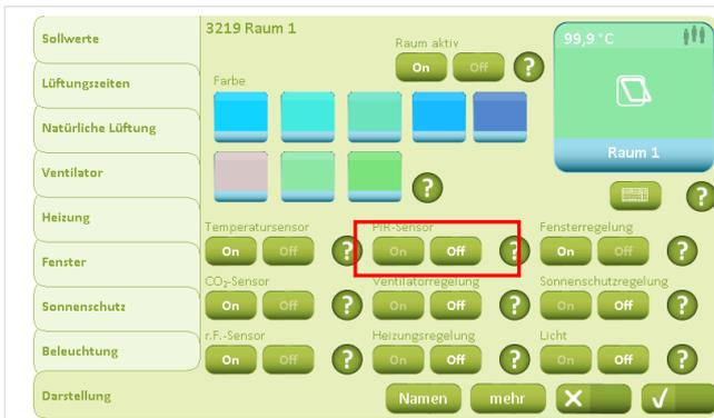
Da die Lüftung auf Basis der Temperatur-, CO<sub>2</sub>- und Luftfeuchtigkeitswerte geregelt werden soll, werden der „PIR-Sensor“, die „Sonnenschutzregelung“ und die „Lichtsteuerung“ auf „Off“ gestellt.
