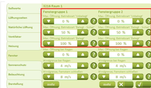
Unter der Registerkarte „Fenster“ wird die maximale Öffnungsweite des Fensters für die einzelnen Räume und verschiedenen Betriebszustände festgelegt.
