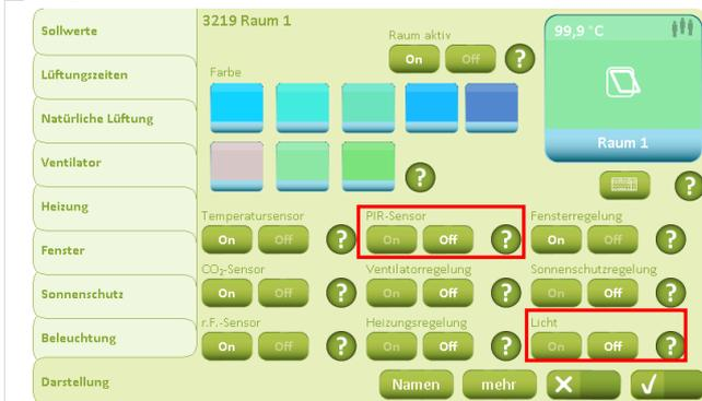
Unter der Registerkarte „Darstellung“ werden die „Lichtsteuerung“ und der „PIR-Sensor“ in allen Räumen, die eine Lichtsteuerung erhalten sollen, auf „On“ gestellt.
