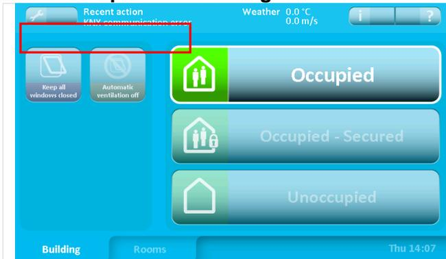
Um in die Menüs der Grundeinstellungen zu gelangen (grüne Anzeige), wird das Icon „Schraubenschlüssel“ links oben im Bedienfeld betätigt.
