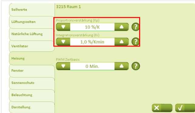
Unter der Registerkarte „Heizung“ wird empfohlen, die Proportionalverstärkung nicht zu hoch zu setzen z.B. 50%/K, da dies zu Instabilität/Schwankungen führen kann.
