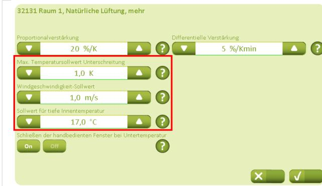
Der maximale Temperaturabfall im Verhältnis zum Temperatur-Sollwert entscheidet, wann die Fenster schließen. Dies ist vor allem bei einer Lüftung zu vorgestellten Zeitpunkten wichtig.
