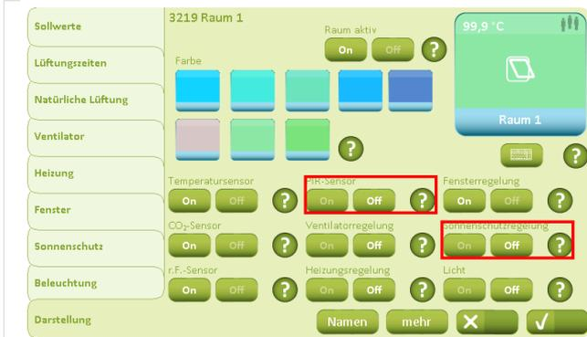
Neben den Sensoren/Funktionen, die bereits in Verbindung mit der Lüftung und der Heizungsregelung aktiviert wurden, muss die Funktion „Sonnenschutz regeln“ auf „On“ gestellt werden.
