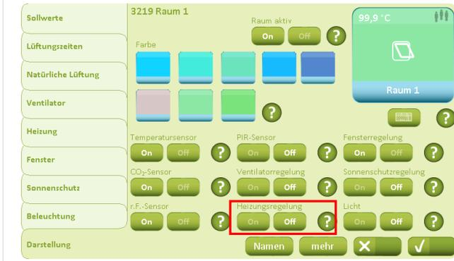
Unter der Registerkarte „Darstellung“ wird die „Heizungsregelung“ in sämtlichen Räumen auf „On“ gestellt, wenn eine Heizungsregelung erfolgen soll.
