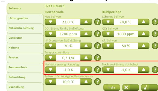
Das NV Comfort® bietet die Möglichkeit der Absenkung des Temperatur-Sollwerts für eine optimierte Nachtauskühlung im Sommer sowie eine mögliche Heizenergieeinsparung im Winter. Hierfür können die Werte für die Nachtabenkung und Nachtauskühlung für „Gebäude unbelegt“ unter der Registerkarte „Sollwerte“ verändert werden.
