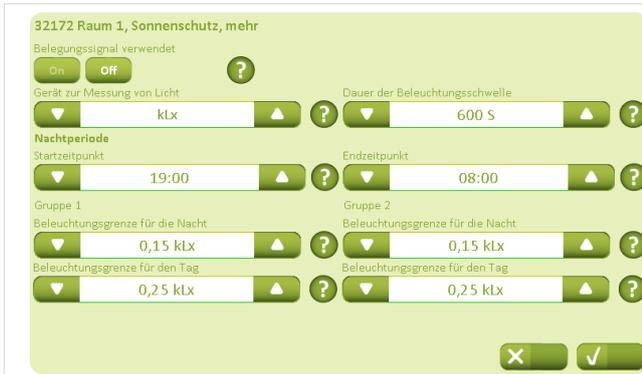
Wird ein PIR-Sensor verwendet, wird „Anwesenheitssignal benutzen“ auf „On“ gestellt.
