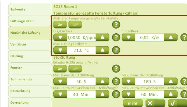
Unter der Registerkarte „Natürliche Lüftung“ wird festgelegt ob die Lüftung temperaturgeregelt werden soll sowie der Einfluss des CO<sub>2</sub>-Gehalts und der relativen Luftfeuchtigkeit auf den gewünschten Sollwert festgelegt. Werden zuvor eingestellte Grenzwerte überschritten, senkt das System den Temperatur-Sollwert in Übereinstimmung mit den Einstellungen.
