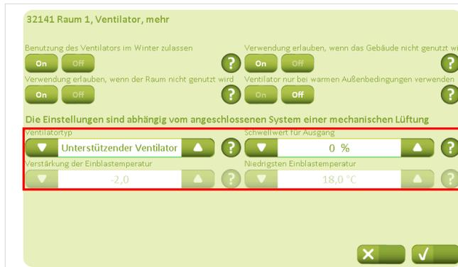
Unter der Registerkarte „Ventilator“ „mehr“ wird festgelegt ob einen FutureVent™ oder einen Unterstützenden Ventilator verwendet wird.
