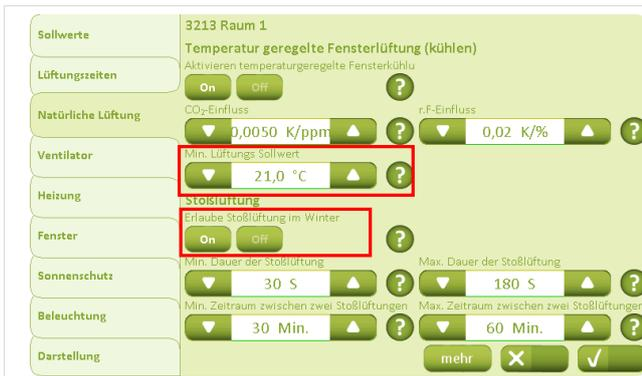
Der „Min. Lüftungs-Sollwert“ kann nach Bedarf eingestellt werden.
