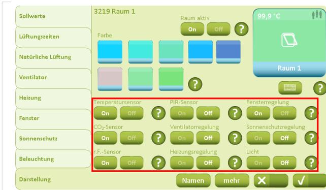
Da nur eine temperaturabhängige Lüftung benötigt wird, sind „CO<sub>2</sub>-Sensor“, „rF-Sensor“, „PIR-Sensor“, „Ventilatorregelung“ und „Heizungsregelung“ auf „Off“ zu stellen.
