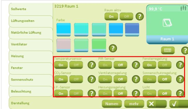
Da die Lüftung auf Basis der Temperatur-, CO<sub>2</sub>- und Luftfeuchtigkeitswerte geregelt werden soll, werden alle diese Sensoren auf „On“ gestellt.
