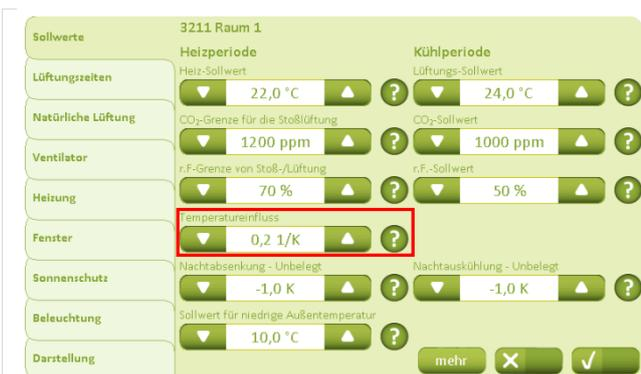
Unter dem Wert „Temperaturerfluss“ wird festgelegt, ob auch im Winter eine Stoßlüftung erfolgen soll, wenn der Temperatur-Sollwert, die relative Luftfeuchtigkeit oder der CO<sub>2</sub>-Sollwert überschritten wird.
