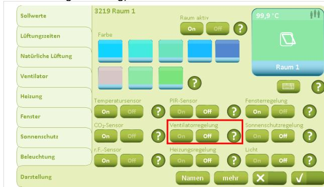
Unter der Registerkarte „Darstellung“ wird die „Ventilatorregelung“ in den Räumen auf „On“ gestellt, in denen eine mechanische Lüftung in das NV Comfort® mit eingebunden werden soll.
