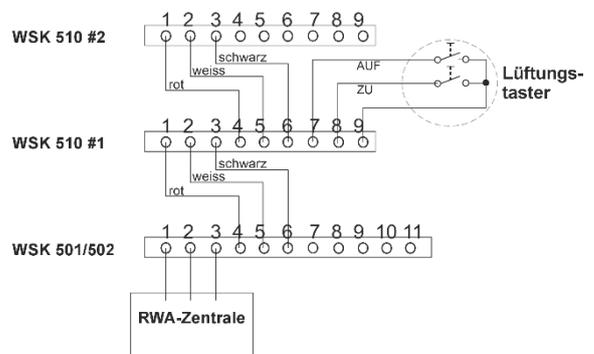
Lüftungstaster können an WSK 510 angeschlossen werden. Rauchmelder können nicht an WSK 510 angeschlossen werden. Pro Zentrale können bis zu 10 Feuerwehrscharer angeschlossen werden Für die Konfiguration siehe bitte Anleitung WSK 510.
