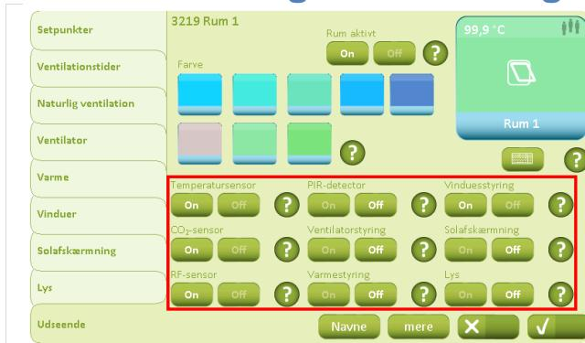
På fanebladet "Udsende" skal "Temperatursensor", "CO<sub>2</sub>-sensor" og "RF-sensor" sættes til "On" i samtlige rum, hvis der ønskes styring af den naturlige ventilation.
