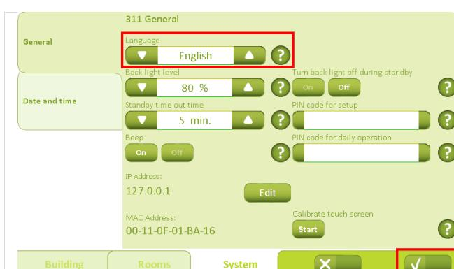
På fanebladet "General" indstilles: sprog, baggrundsbelysning, tiden hvorefter baggrundsbelysningen skal gå i dvalemode, bib-lyd når der tastes samt PIN-kode for superbruger hhv. slutbruger.
