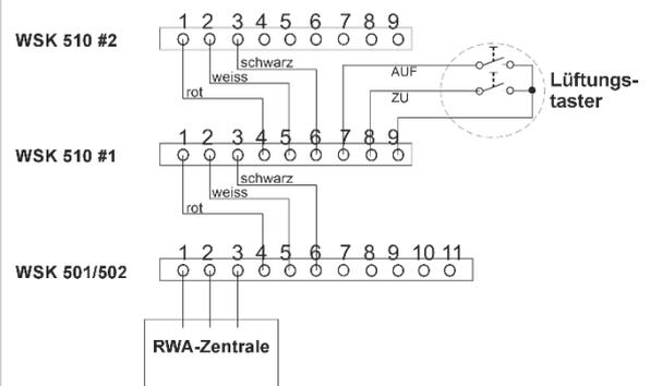
Lüftungstaster können an WSK 510 angeschlossen werden. Rauchmelder können nicht an WSK 510 angeschlossen werden. Pro Zentrale können bis zu 10 Feuerweherschalter angeschlossen werden. Für die Konfiguration siehe bitte Anleitung WSK 510.
