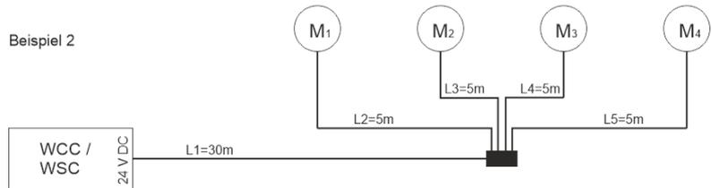
Gesamtleitungslänge =  $L_1 + L_2 + L_3 + L_4 + L_5 = 30m + 5m + 5m + 5m + 5m = 50m$
