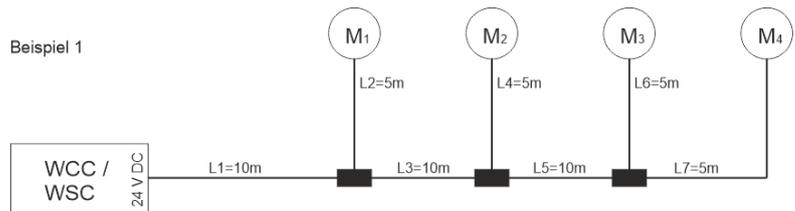
Gesamtleitungslänge =  $L_1 + L_2 + L_3 + L_4 + L_5 + L_6 + L_7 = 10m + 5m + 10m + 5m + 10m + 5m + 5m = 50m$
