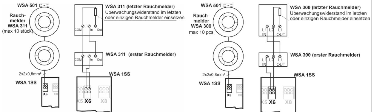
Wenn kein Rauchmelder an Klemme X6 angeschlossen ist, muss ein 10kΩ Widerstand an X6 angeschlossen werden.
