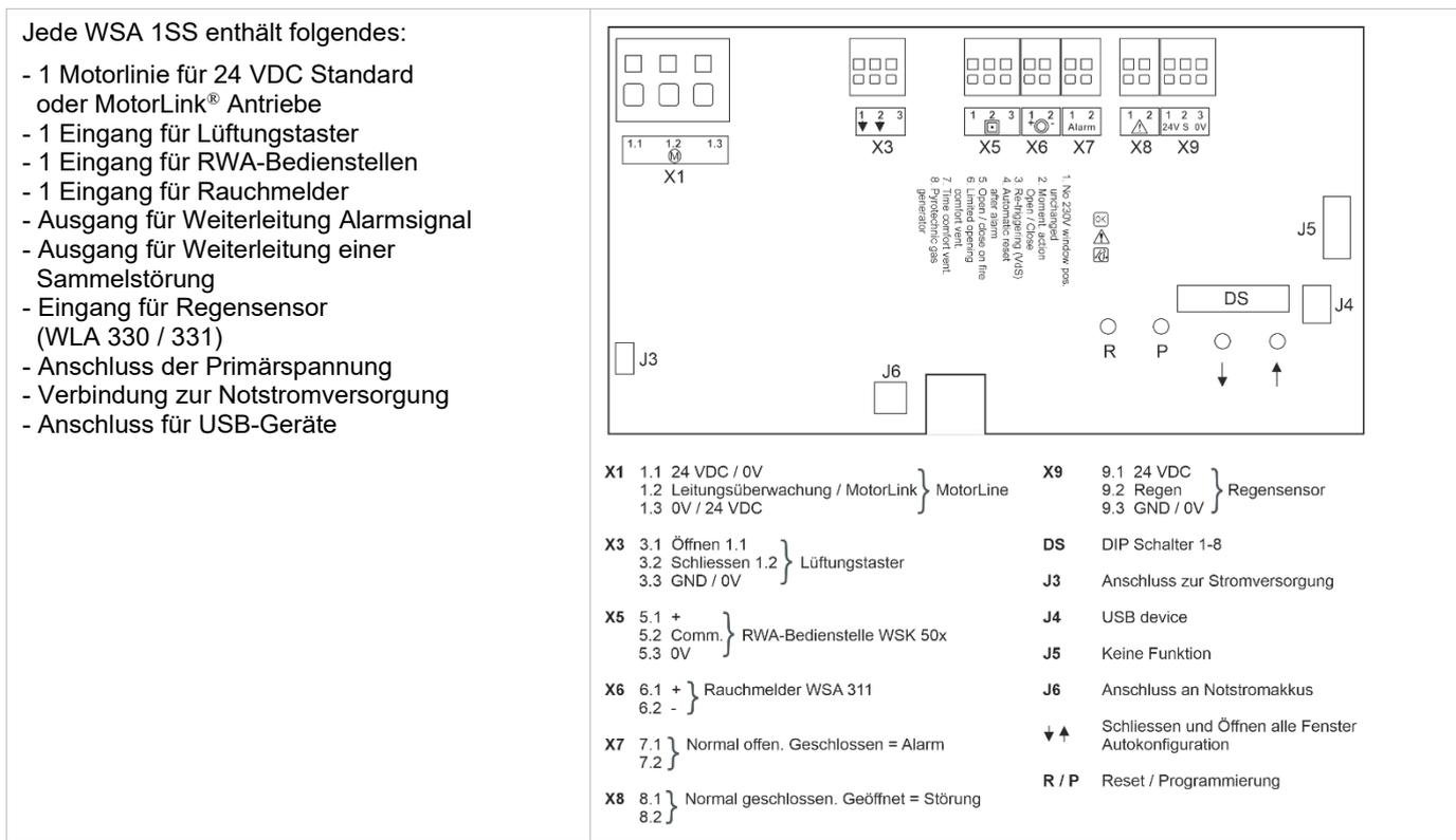
**X1** Die WSA 1SS Platine hat 1 Motorlinie für den Anschluss von 24 VDC Standard Antriebe, MotorLink® Antriebe oder Druckgaserzeuger.
