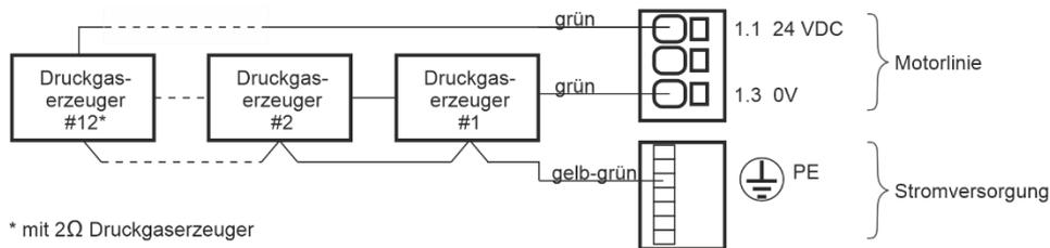
Ein elektromagnetischer Auslöser wird über die Motorline an die RWA-Zentrale angeschlossen.
