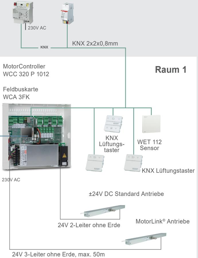
**Beispiel 5: WCC 320 P 1012 mit BACnet MS/TP / Modbus RTU/RS485 Karte erweitert oder BACnet-IP Schlüssel**
