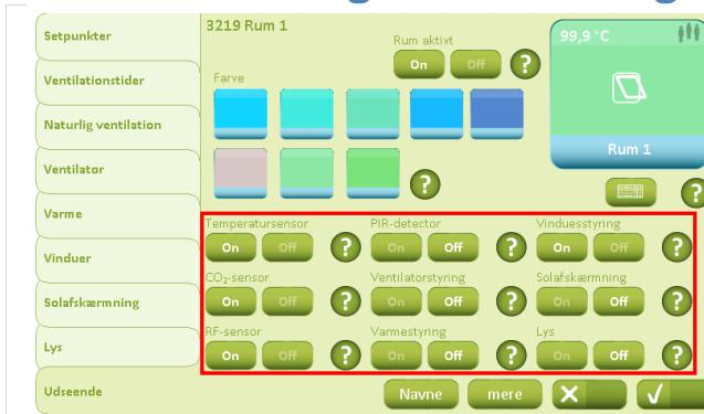
På fanebladet "Udsende" skal "Temperatursensor", "CO<sub>2</sub>-sensor" og "RF-sensor" sættes til "On" i samtlige rum, hvis der ønskes styring af den natrige ventilation.
