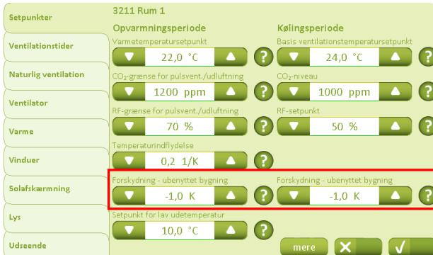
NV Comfort™ giver mulighed for sænkning af temperatursetupunktet enten for at foretage en natkøling om sommeren eller en varmebesparelse om vinteren. Til dette kan felterne for temperaturforskydning "ubenyttet bygning" anvendes under fanebladet "Setpunkter".
