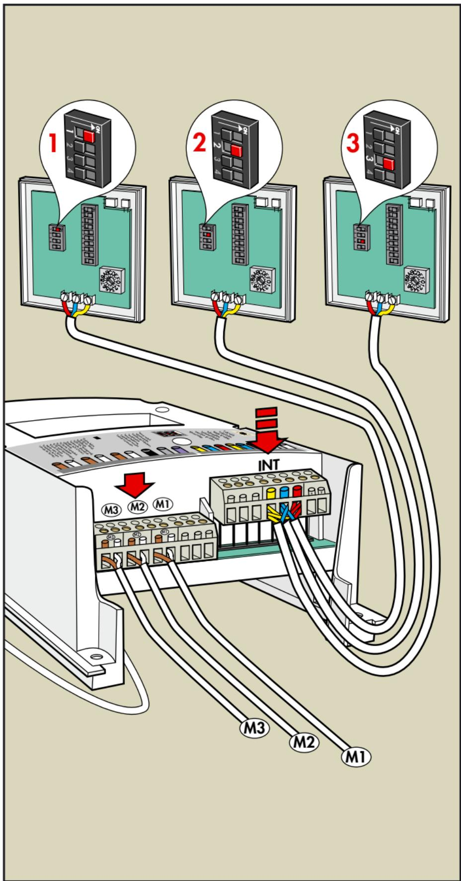
**Nederlands:** De drie motoren kunnen afzonderlijk bediend worden middels aparte bedieningspanelen. Verbind de kabels van de bedieningspanelen met de uitgang "INT" van het bedieningssysteem. Stel de schakelaars van elk bedieningspaneel in: Zet de schakelaar met hetzelfde nummer als de motor die in werking gesteld moet worden, op "ON".
