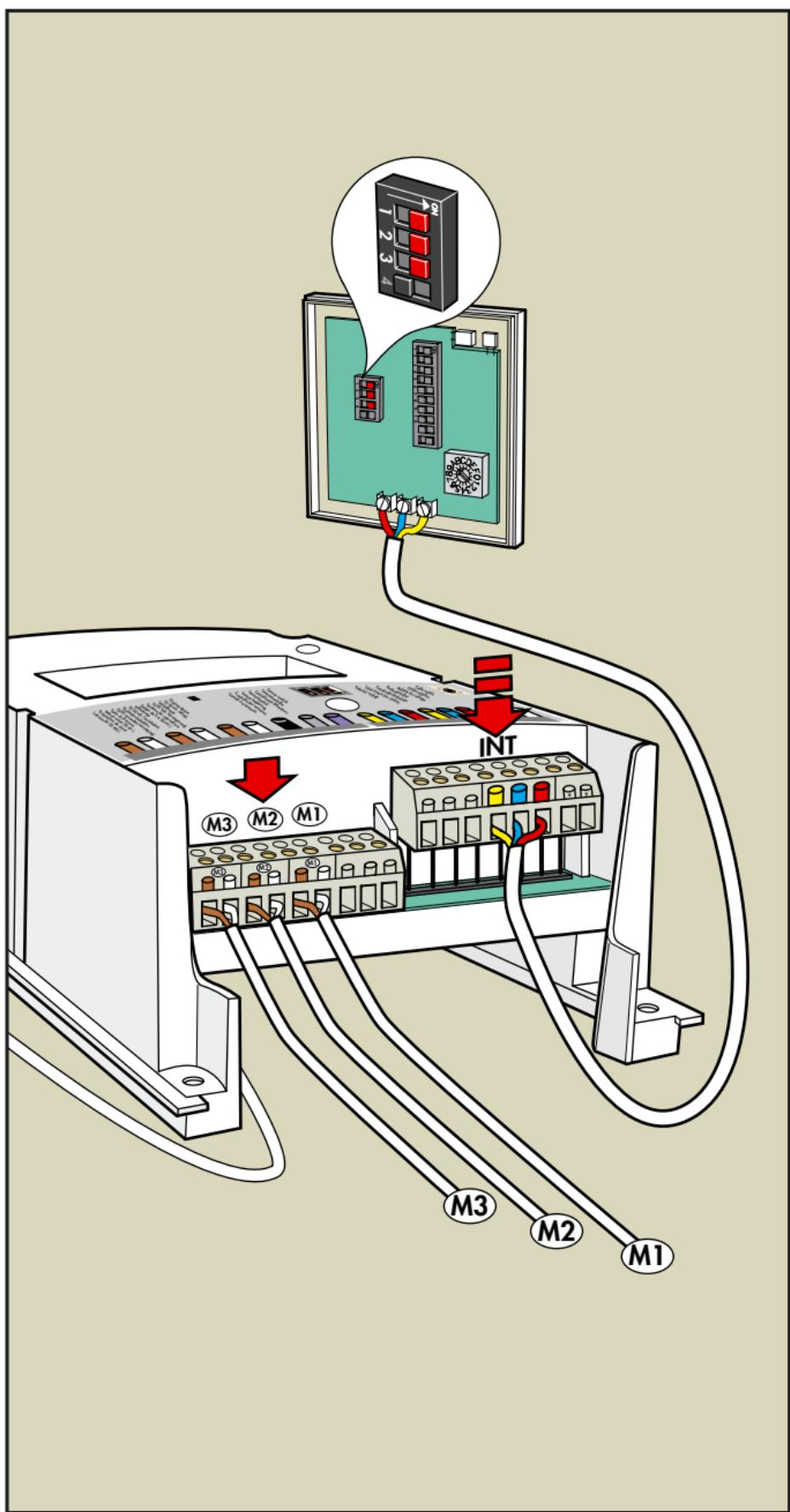
**Nederlands:** Er kunnen drie motoren bediend worden met een druk op hetzelfde bedieningspaneel; de motoren zullen opeenvolgend geactiveerd worden. Verbind de kabel van het bedieningspaneel met de uitgang "INT" van het bedieningssysteem. De schakelaars **1, 2 en 3** op het bedieningspaneel op "**ON**" zetten.
