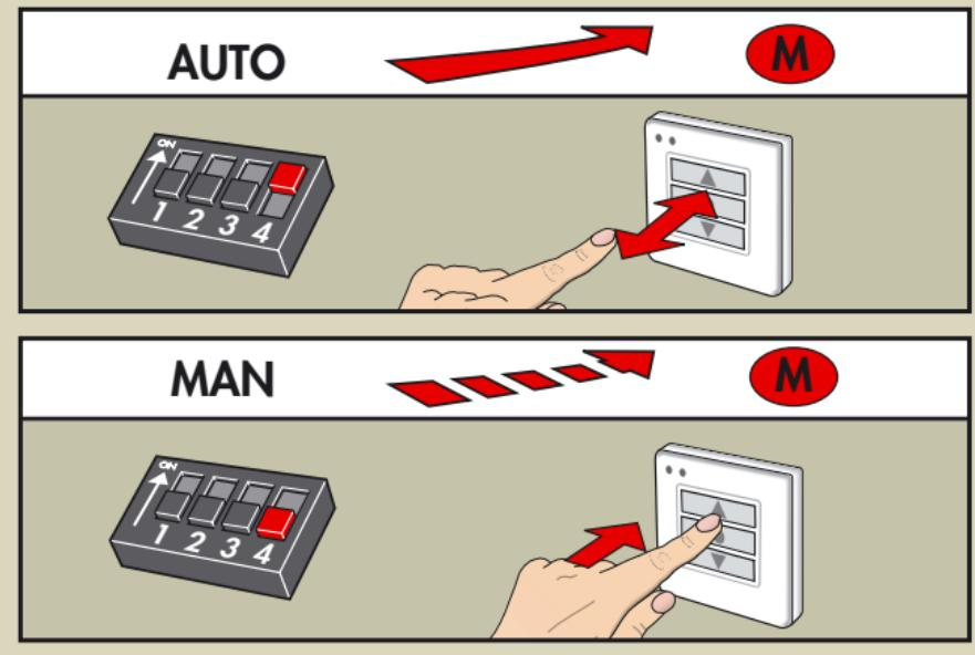
**Nederlands:** Als een schakelaar (1, 2 of 3) in de stand "AUTO" (automatisch) wordt gezet, zal de motor na een druk op de knop de opdracht geheel uitvoeren. Als de schakelaar in de stand "MAN" wordt gezet (handbediening), zal de motor alleen lopen zolang de knop wordt ingedrukt (dit wordt aanbevolen voor een electrisch bedienende jaloezie).
