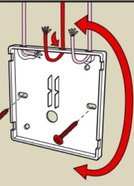
**Nederlands:** Bevestig het bedieningspaneel WLI 110 aan de wand. **Verborgen bedrading (A):** Trek de kabel door het gat in de onderplaat. **Zichtbare bedrading (B):** Bepaal waar u de kabel naar binnen wilt brengen. Maak de opening in het bedieningspaneel op de gewenste plaats door het dunne gedeelte eruit te drukken. Als de kabel aan de bovenzijde binnen komt dient u de onderplaat 180° te draaien.
