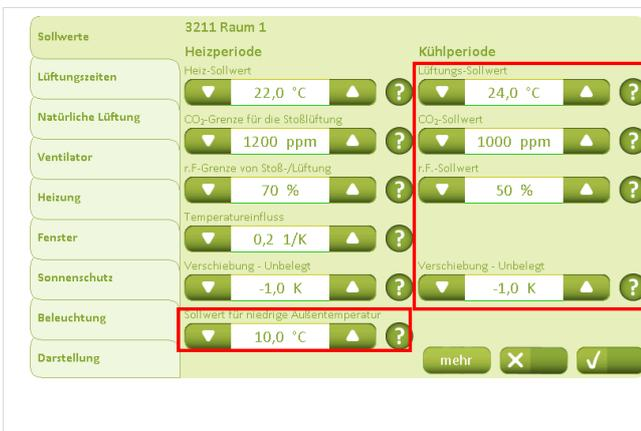
Unter „Heizperiode“ können die Sollwerter für den Wintermodus eingestellt werden. Unter „Sollwert für niedrige Außentemperatur“ kann der Sollwert für den Wechsel zwischen Sommer- und Wintermodus eingestellt werden.
