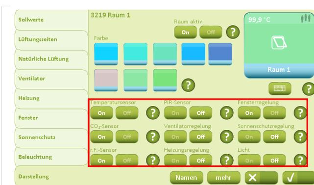
Da die Lüftung auf Basis der Temperatur-, CO<sub>2</sub>- und Luftfeuchtwerte geregelt werden soll, werden alle diese Sensoren auf „On“ gestellt.
