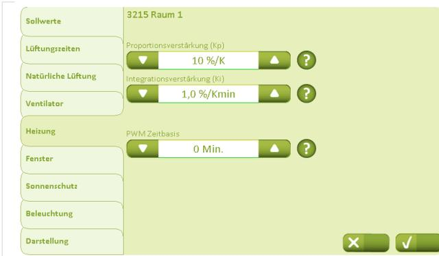
Die Parameter für die Heizungsregelung können nach Bedarf eingestellt werden.
