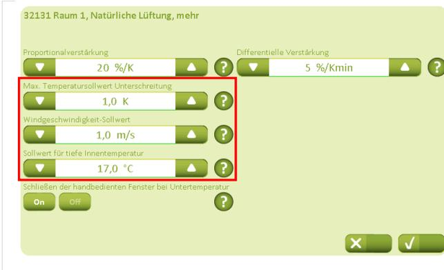
Der maximale Temperaturabfall im Verhältnis zum Temperatur-Sollwert entscheidet, wann die Fenster schließen. Dies ist vor allem bei einer Lüftung zu voreingestellten Zeitpunkten wichtig.
