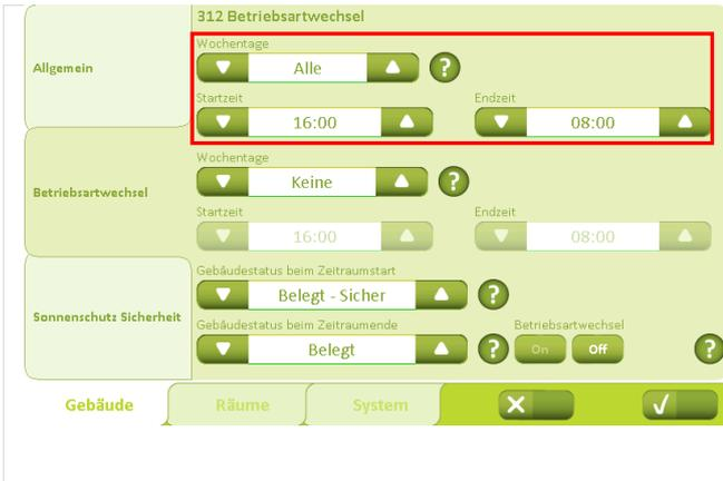
Unter der Registerkarte „Gebäude“ – „Betriebsarten“ wird der Zeitraum für den automatischen Wechsel zwischen den Betriebsarten eingestellt.
