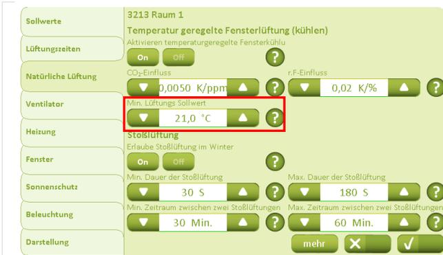
Unter der Registerkarte „Natürliche Lüftung“ beschreibt der „Min. Lüftungs-Sollwert“ den kleinsten Temperatur-Sollwert, bis zu dem vom System die natürliche Lüftung ausgeführt werden darf.
