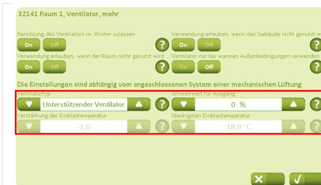
Unter der Registerkarte „Ventilator“ „mehr“ wird festgelegt ob einen ZoneVent™ oder einen Unterstützenden Ventilator verwendet wird. Es kann raumweise immer nur ein Ventilator oder ein ZoneVent™ angeschlossen werden!
