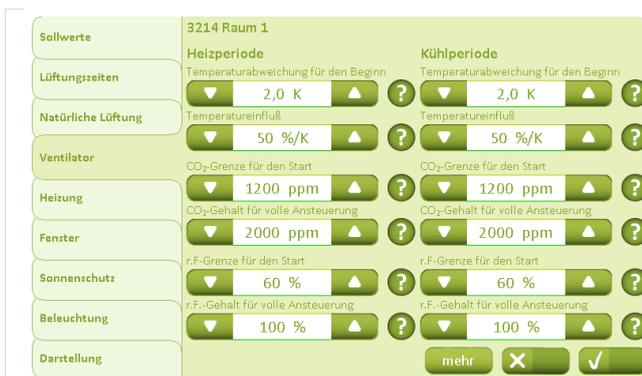
Unter der Registerkarte „Ventilator“ werden die Ventilator-Sollwerte für die Heiz- bzw. Kühlperiode angegeben. Der Sollwert für „Temperaturabweichung für den Beginn“ geht vom Lüftungstemperatur-Sollwert aus, der unter „Sollwerte“ (Kapitel 5.1.1) festgelegt wurde.
