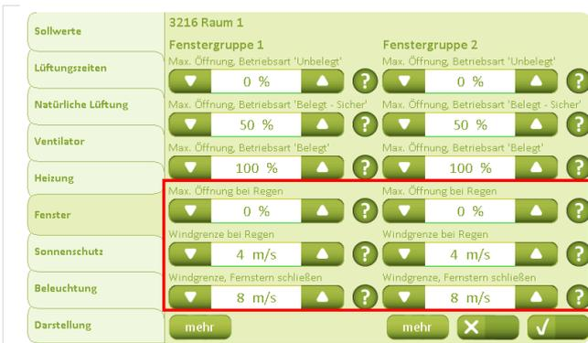
Unter der Registerkarte „Fenster“ wird die maximale Öffnungsweite des jeweiligen Fensters (bzw. einer Fenstergruppe) bei Regen eingestellt. Außerdem wird der Sollwert für Windgeschwindigkeit mit oder ohne Regen definiert. Bei einer Überschreitung dieser Grenzen schließen die Fenster automatisch.
