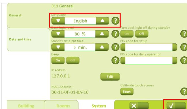
Unter der Registerkarte „General“ („Allgemein“) können folgende Parameter eingestellt werden: Sprache / Hintergrundbeleuchtung / Zeit, nach der die Hintergrundbeleuchtung in den Ruhezustand wechselt / akustisches Signal, wenn eine Eingabe erfolgt sowie PIN-Code für den Super-User bzw. Endnutzer. Außerdem kann das Schirmbild kalibriert werden.
