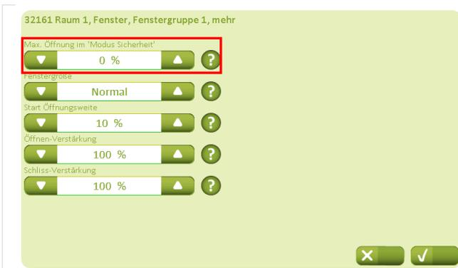
Mit den Werten für „Max. Öffnung“ im Modus „Sicherheit“ wird die maximal zulässige Fensteröffnungsweite im Fall von Systemstörungen angegeben.
