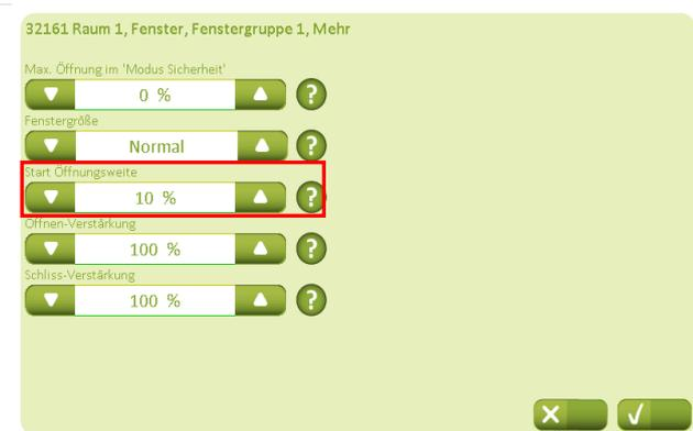
Mit dem Wert „Start Öffnungsweite“ wird die Mindestöffnungsweite der Fenster definiert, die auf die Regelung der natürlichen Lüftung Einfluss hat. Ein Luftwechsel über eine Spaltlüftung ist erst dann möglich, wenn sich die Dichtungen vom Rahmen gelöst haben.
