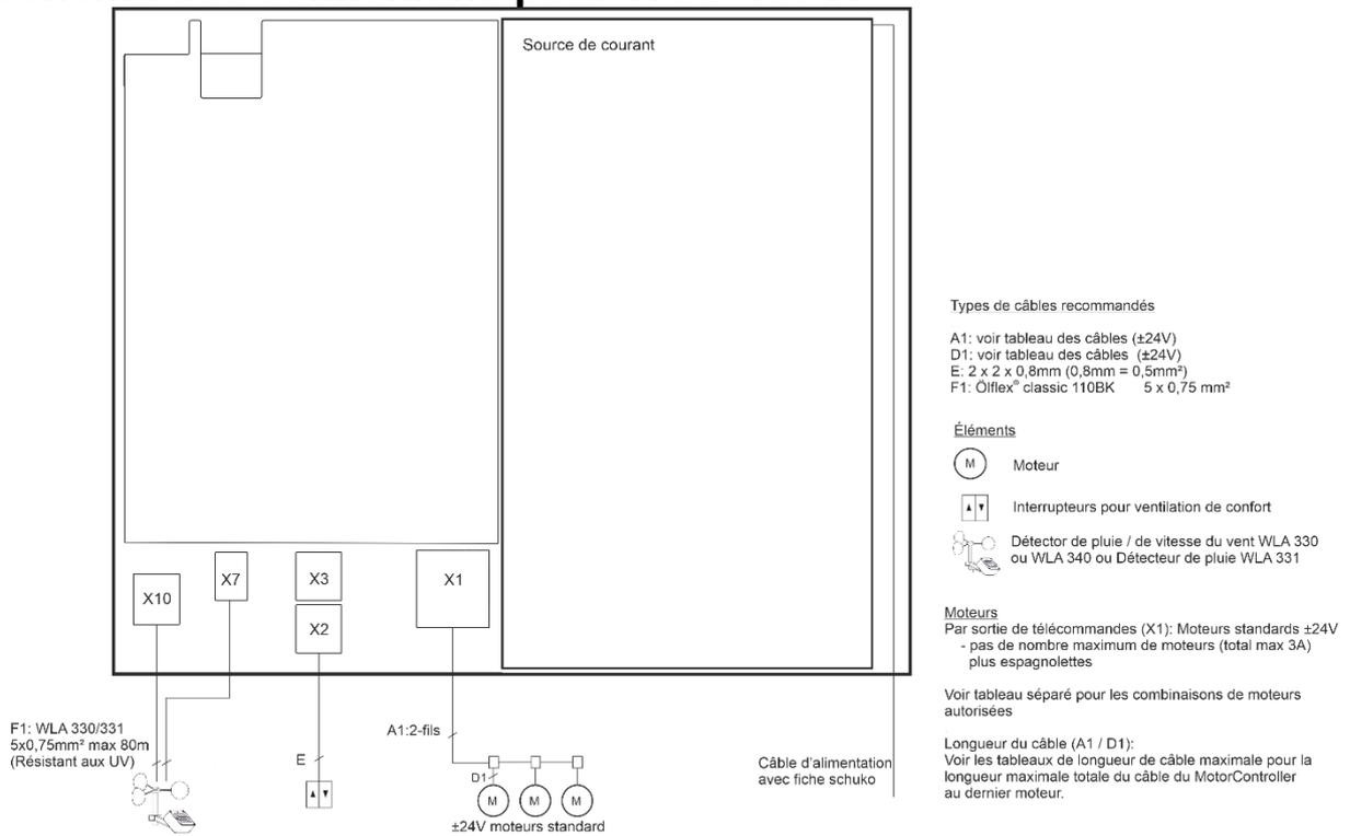
Le schéma des connexions ci-dessus montre un MotorController (armoire de commande) WCC 103 A
