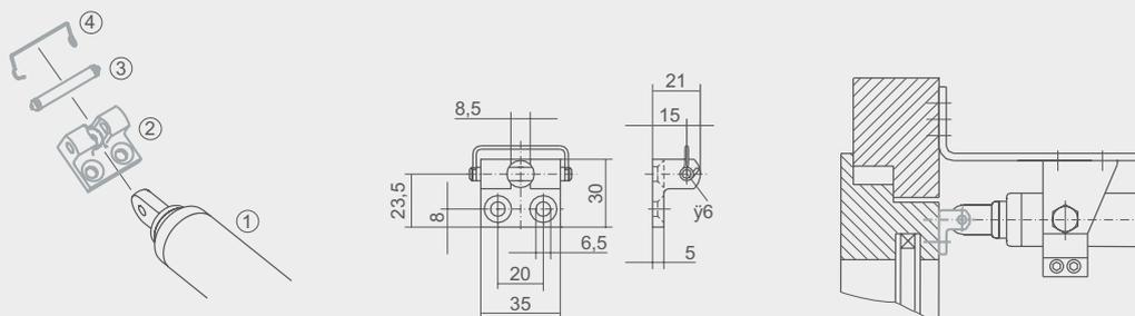
1.Spindelantrieb 2. Flügelbock 3. Stift 4. Sicherungsbügel
