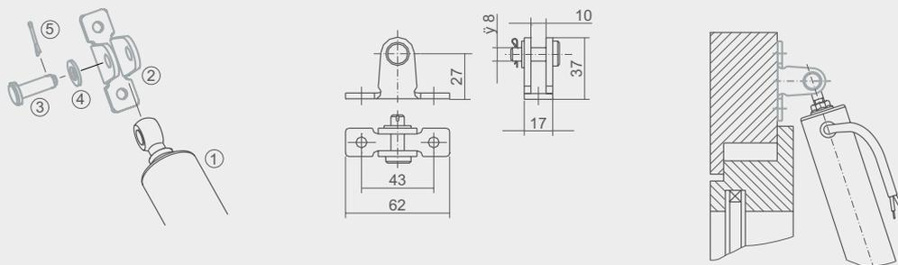
1.Spindelantrieb 2. Flügelbock 3. Bolzen 4.Scheibe 5. Splint
