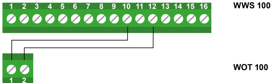
Udetemperatursensoren WOT 100 er forbundet til hhv. #10 Sensorindgang 3 og #12 GND på WWS 100
