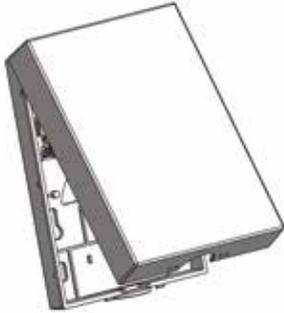
Öffnen Sie den Kasten unten und entfernen Sie die vordere Abdeckung! Entfernen Sie das Flachbandkabel!
