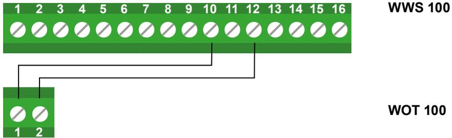
Der Außentempersensur WOT 100 wird an #10 und #12 bzw. Sensoreingang 3 und GND am WWS 100 angeschlossen.
