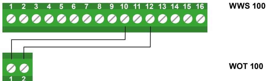
Le capteur de température extérieure WOT 100 est connecté aux entrées #10 et #12 Entrée capteur 3 et GND respectivement sur WWS 100.
