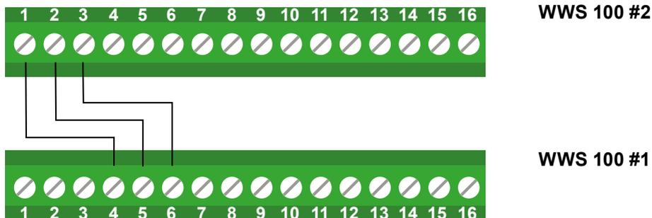
Le Capteur WWS 100 est raccordé au 5X ou 6X sur le panneau de ventilation de fumée (l'entrée pour l'unité de bris de glace ou au Master-Slave).
