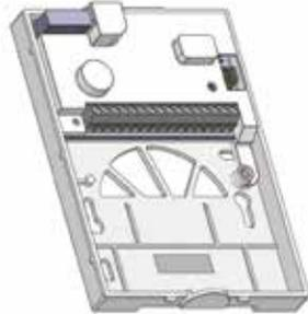
Befestigen Sie die hintere Abdeckung an einer Wand.
