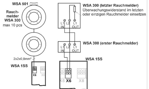
Wenn kein Rauchmelder an Klemme X6 angeschlossen ist, muss ein 10kΩ Widerstand an X6 angeschlossen werden.
