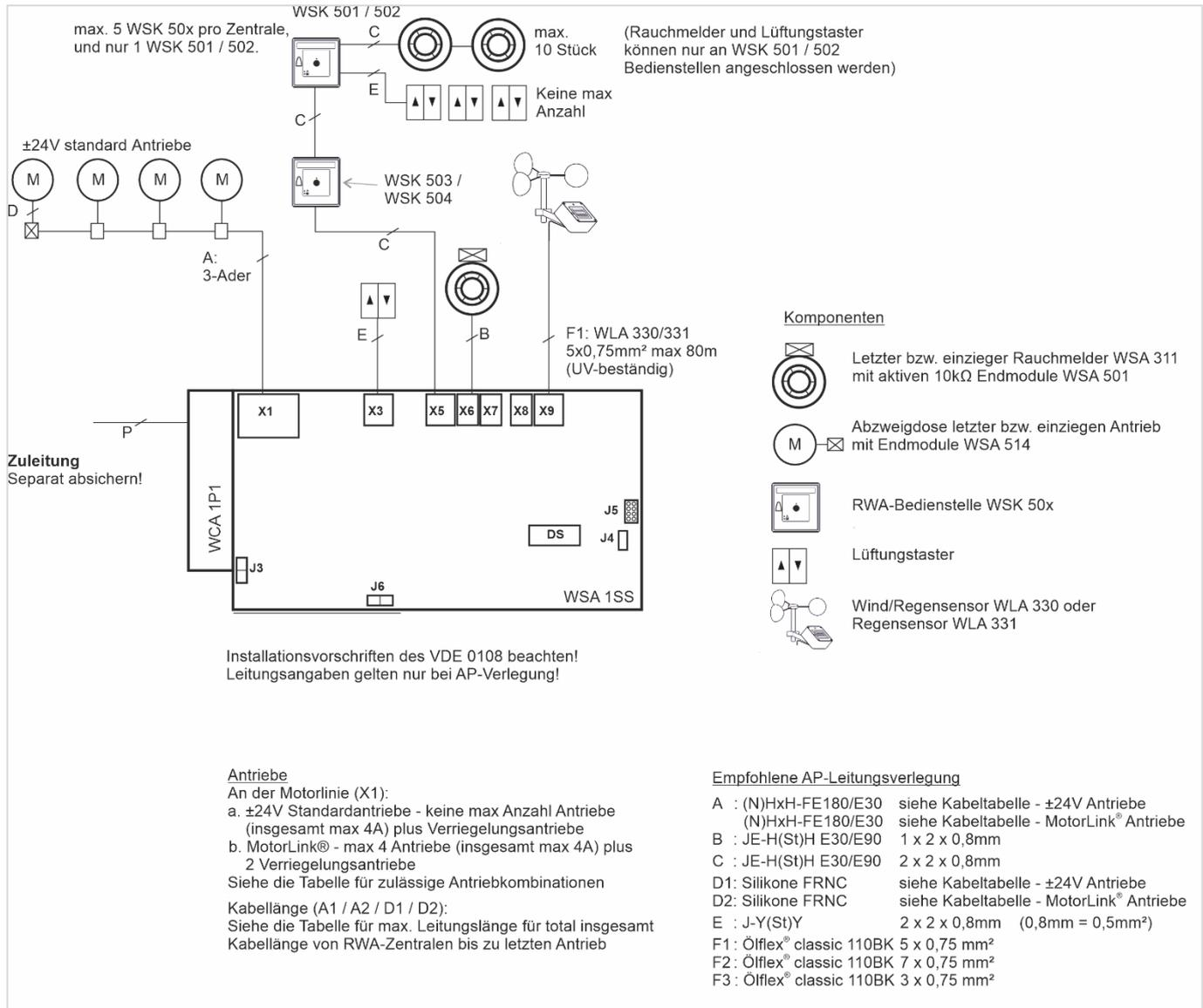
Der Plan oben zeigt die WSC 104 mit angeschlossenen 24 VDC Standardantrieben.
