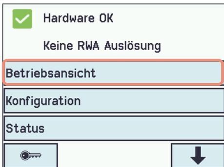
Wir haben die am häufigsten verwendeten Konfigurations- und Statusparameter unter dem Hauptmenüpunkt „Betriebsansicht“ zusammengefasst, um den Zugriff zu erleichtern.
