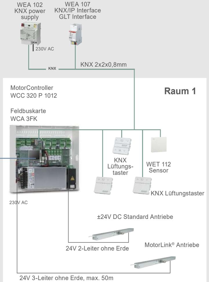
**Beispiel 4: WCC 320 P 1012 mit BACnet MS/TP / Modbus RTU/RS485 Karte erweitert oder BACnet-IP Schlüssel**
