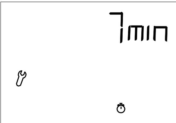
1. Das Display zeigt die Kontroll-Intervallzeit „7 min“ an und die Uhr blinkt.
