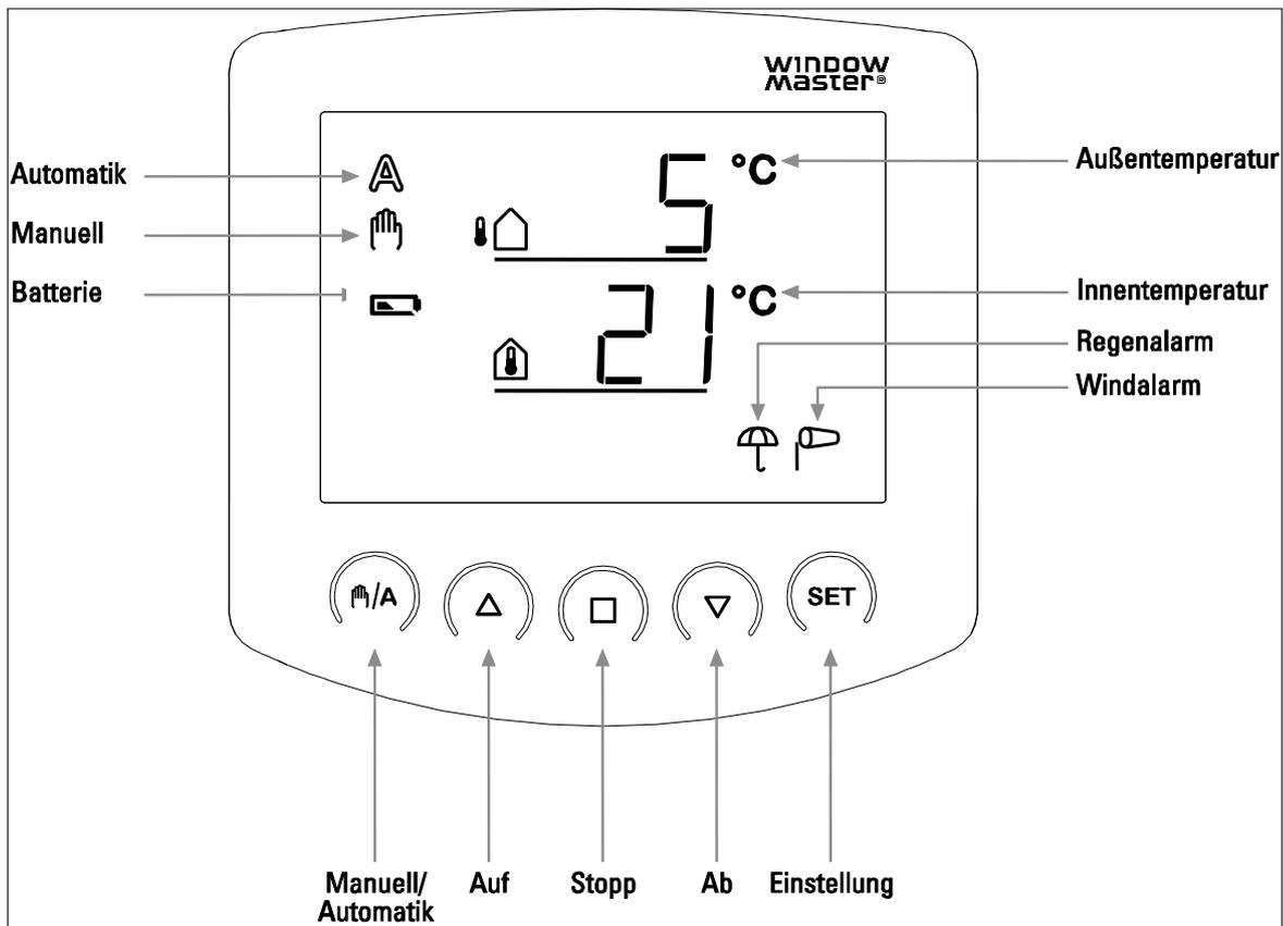
Das Bedienteil zeigt die Steuerungssignale, die Außen- und Innentemperatur sowie eventuell Regen- oder Windalarm an. Des Weiteren wird die Bedienungseinstellung angezeigt und eventuell auch der Batteriestatus. Die Wetterdaten werden einmal pro Minute aktualisiert.
