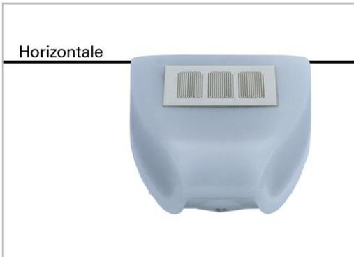
Die Wetterstation muss in der Querrichtung horizontal (waagrecht) montiert sein.
