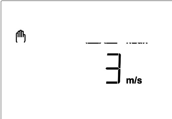
Hinweis: In den ersten ca. 90 Sekunden nach einer Spannungswiederkehr an der Wetterstation wird der Windwert nicht korrekt angezeigt (z. B. nach Stromausfall oder bei Inbetriebnahme). Bei eingeschaltetem Windalarm ist darum in dieser Zeitspanne die manuelle Bedienung gesperrt.
