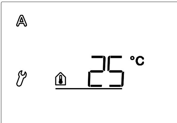
Die Hysterese beträgt 2°C, d.h. die Fensterlüftung wird wieder geschlossen, sobald die Innentemperatur mehr als 2°C unter den eingestellten Wert sinkt.
