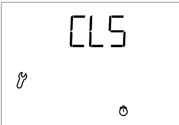
1. Das Display zeigt **CLS** (CLS=schließen) an und die Uhr blinkt.
