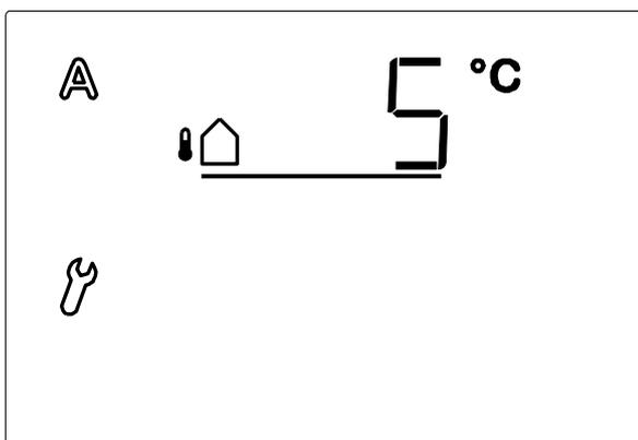
Die Hysterese der Außentemperatursperre beträgt 2°C, d.h. die Fensterlüftung wird erst wieder freigegeben, wenn die Außentemperatur mehr als 2°C über den eingestellten Wert steigt.
