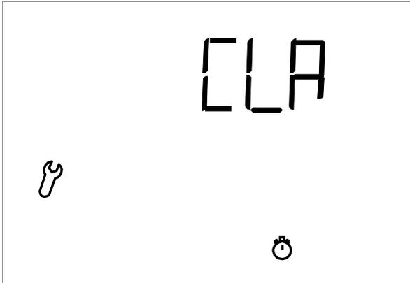
1. Das Display zeigt (CLR=löschen) an und die Uhr blinkt.
