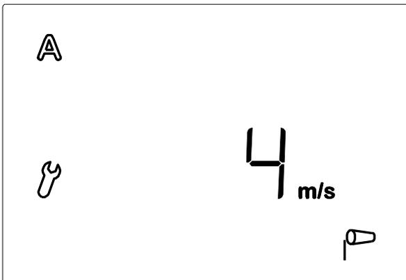
Bei Blinken des Windalarm-Symbols kann der Wert für den Windalarm über  $\Delta$   $\nabla$  oder das Drücken von **OFF** (bei 21 m/s und 0 m/s) eingestellt werden.
