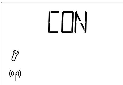
Die Antenne blinkt, also kann die Verbindung zwischen dem Bedienteil und der Wetterstation eingelesen werden.
